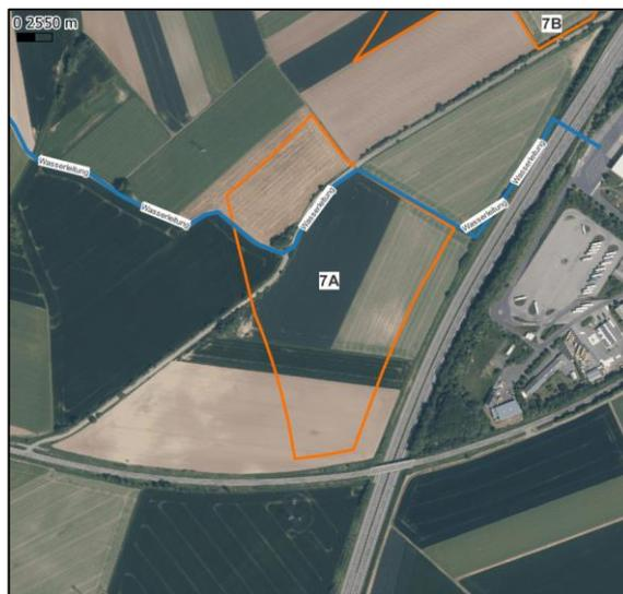
Abbildung 23: Verlauf der Haupttransportleitung der Wasserversorgung gemäß Lageskizze Stadtwerke Mayen GmbH
