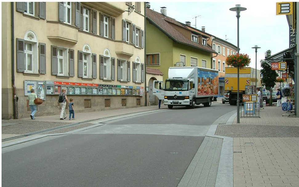
Abbildung 60: Vorgezogener Seitenraum in Wehr
