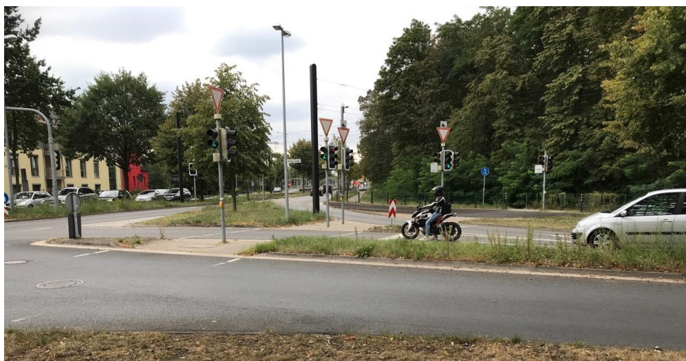
Abbildung 62: Lichtsignalanlage mit mehrfacher Signalgebung
