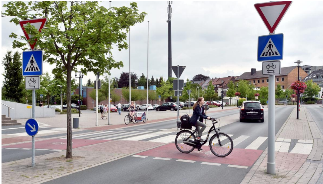
Abbildung 64: Radfahrerfurt und Fußgängerüberweg [Westfälischer Anzeiger 2018 | ©Eickmann]
