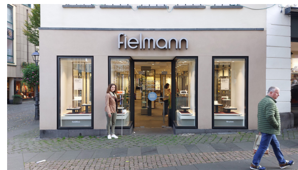
Abb. 102 Modernes Mayener Schaufenster in der Marktstraße mit Adaption des traditionellen Basaltlava-Sockels. Die Pfeiler-Gliederung ist auf den Rhythmus der Öffnungen in den Obergeschossen bezogen. Foto: Johannes Buchhammer, Oktober 2024
